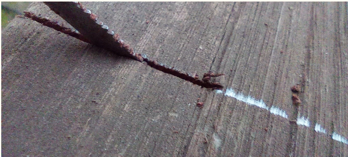
Figura 2. Líneas en tejuela y línea de sierra, Río Bueno, de Pedro Pablo Achondo
